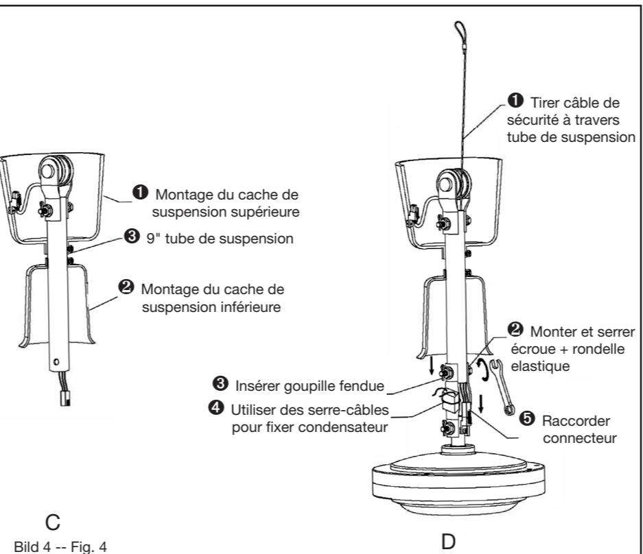
Remarque: La hauteur de chute par rapport à la corde de sécurité doit être respectée.
